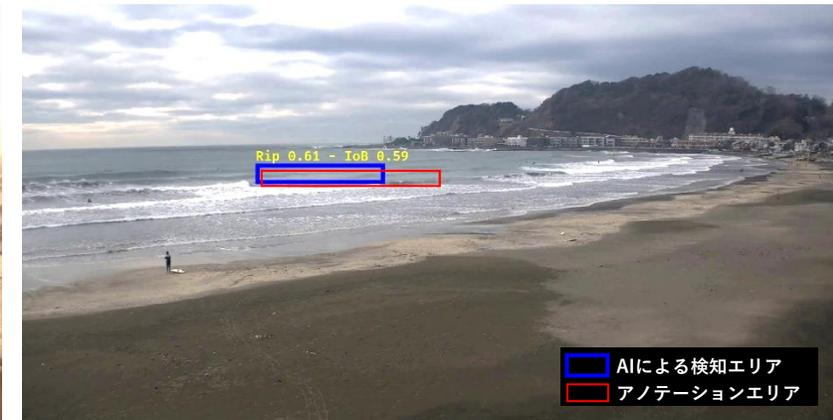
Fig. 9 構築したAIによる離岸流の検知結果の例
