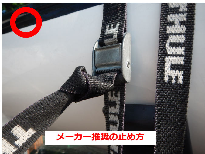
購入時、装着時から経年で緩む場合があるので、積載毎にゆるみやがたつきの点検を行う。
