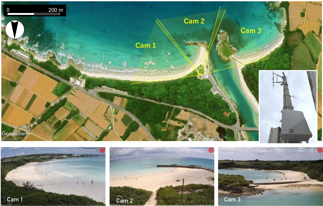
Fig. 4 Webカメラの設置位置と撮影画像
